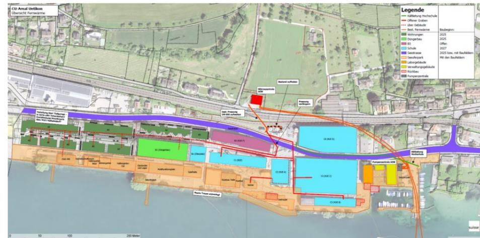
Konzeptplan Fernwärme, Areal- und Baufelderschliessung
